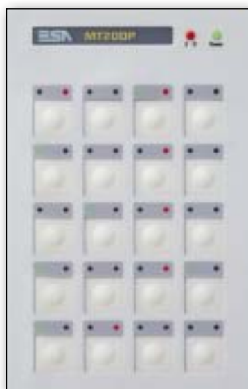
MT20DP Teclado de 20 teclas, cada uno con 2 LEDs y zumbador.
