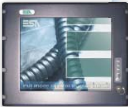
PC222x LCD 256k Colores TFT 1024 x 768 (15")
